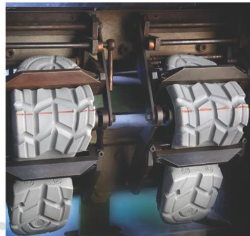
دستگاه آزمون کیفیت زیره Sole flex test machine
